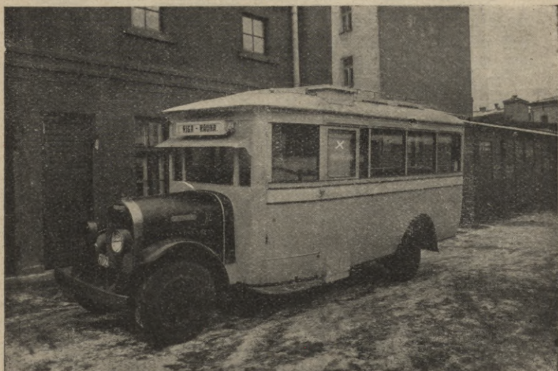
7. zīm. Ar X atzīmētā vietā iebūvēts ģenerators autobusā iekšpusē aiz vadītāj vietas.
