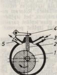
4.13. att. Stacionārās plāksnes vakuumsūkņa shēma.
