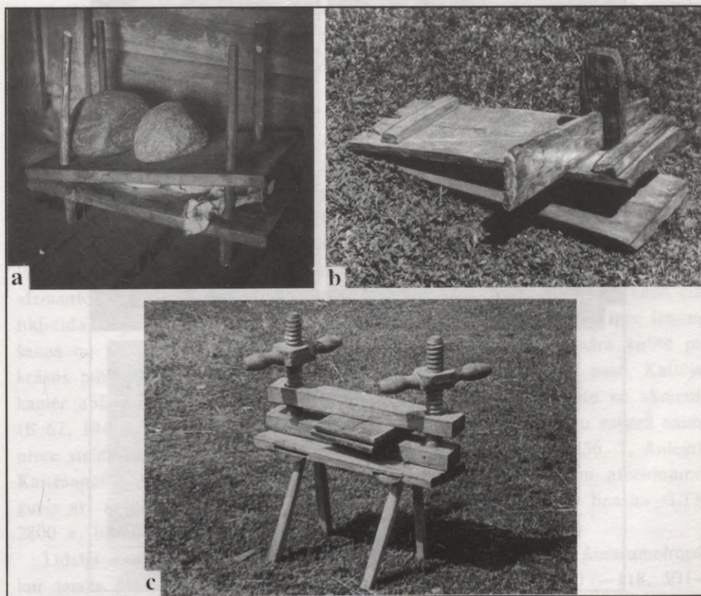
83. att.: a — biežpiena siera nospiešana presē zem akmeņiem. Ilūkstes apr. Dvietes pag. Pupiņās. 1937. g. (LVM, 7772. neg.); b — siera spiede ar ķīli. Abrenes apr. Baltinavas pag. 1964. g. (E, 1098-5. neg.); c — siera spiede ar koka skrūvēm. Ludzas apr. Pildas pag. 1964. g. (E, 1211-6. neg.).
