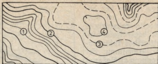
28. att. Horizontāļu veidi topogrāfiskajās kartēs: 1 — pamathorizontāles, 2 — uzsvērtās pamathorizontāles, 3 — pushhorizontāles, 4 — palīghorizontāles.
