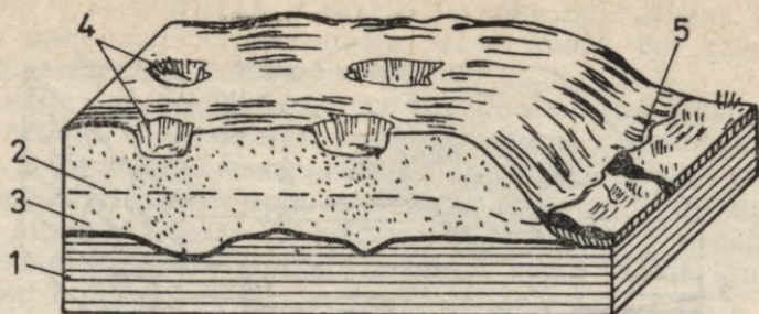
69. att. Sufozijas iegrimumu veidošanās (pēc Z. Maldava): 1 — ūdens necaurlaidīgais slānis, 2 — gruntsūdens līmenis, 3 — ūdeni saturošais slānis, 4 — sufozijas piltuves, 5 — avoti.
