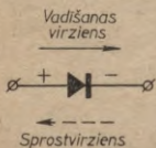
1-10. zīm. Pusvadītāju diodes shematiskais apzi-mējums.
