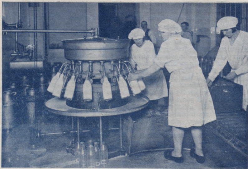
L. P. C. S. Rīgas piencentrāles automātiskā pudeļu pildīšanas aparāta un pašdarbīgā kastu transportieru telpas.
