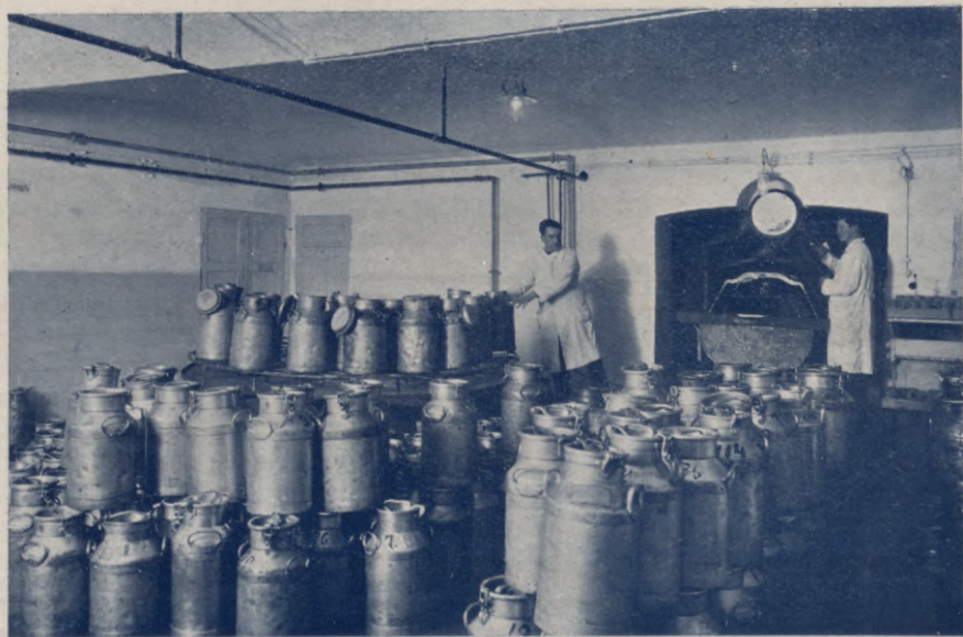
L. P. C. S. Rīgas placentrālās piena pieņemšanas un šķirošanas telpas ar automātiskiem svariem un priekšfiltru.
