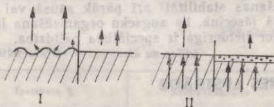
1.31. att. Ūdens iztvaikošanas samazināšana: I — nolīdzinot lauka virsmu, II — sekli uzirdinot blīvu augsni.
