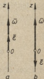
4.47. zīm. Leņķiskā ātruma ( \omega ) un leņķiskā paātrinājuma ( \varepsilon ) vektori paātrinātā ( a ) un palēninātā ( b ) rotācijā
