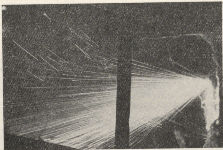
36. att. Minerālvates iegūšana ar saspiestu gaisu sašķiedrējot izkausēto ķieģeļu šķembu un dolomītu maisījumu
