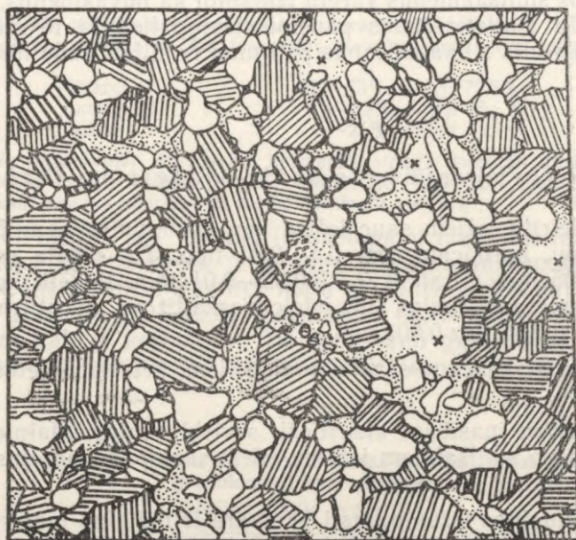
39. att. Ar glaukonītu bagāta dolomītsmilšakmens uzbūves aina mikroskopā
