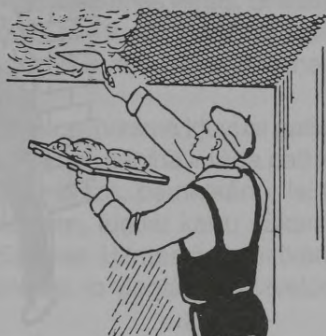
1.23. att. Javas uzvilšana uz griestiem ar ķelli
