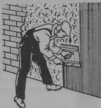
1.20. att. Javas uzvilšana uz sienas ar jauturi
