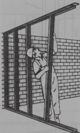
2.34. att. Starpsienas karkasa statņu montāža
