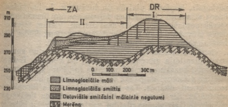
1. att. Gaiziņkalna ģeoloģiskais šķērsgriezum.
