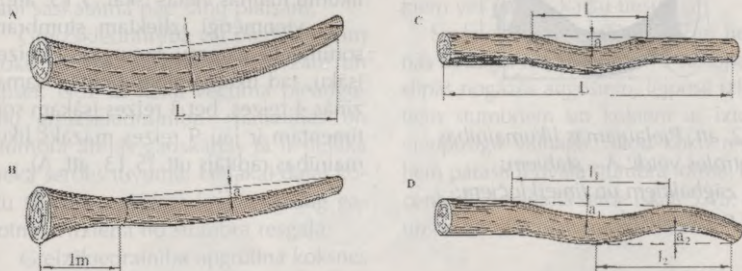
5.11. att. Dažādi likumainības veidi un uzmērīšanas principi: A – labākais vispārējās likumainības uzmērīšanas princips; B – iespējamais vispārējās likumainības uzmērīšanas veids pirmā resgaļa sortimentam; C – vietējās likumainības uzmērīšana; D – daudzpusīgās likumainības uzmērīšana.
