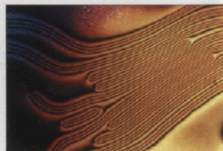
Gaismas frekvences dubultošana. Neodima lāzera stars ( \lambda = 1,06 \mu\text{m} ) bārija niobāta kristālā ierosina otro harmoniku ( \lambda = 0,53 \mu\text{m} )
