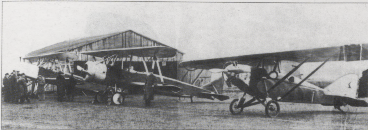
"Backman" lidmašinas. No kreisās: Margera Ņeina pārprojektētais mācību četrvietīgais divplāksnis ar 185 ZS BMW motoru; oriģinālā "Backman" mācību lidmašīna ar 130 ZS "Clerget" motoru; divvietīgais "Vanadziņš" I-4 ar 45 ZS "Anzani" motoru (foto no P. Brankes personiskā arhīva)
