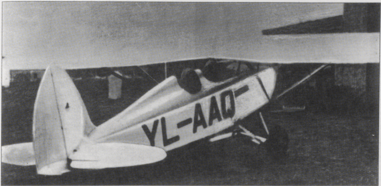
"Zilais putns" I-8 ar 110/125 ZS "Armstrong Siddeley Genet" dzinēju un spraugu aizplākšņiem
