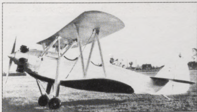
Mācību lidmašīna KOD-1 ar 110 ZS "Armstrong Siddeley Genet" radiālo dzinēju (visi foto no G. Novicka personiskā arhīva)
