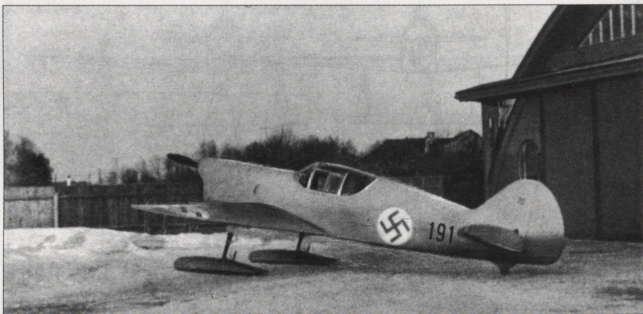
Militārajai mācību lidmašīnai VEF I-15b, šeit uz slēpēm, salīdzinājumā ar I-15a pilota kabīne bija pārvietota uz priekšu. Tai bija "De Havilland Gipsy Six II" dzinējs ar konstanta ātruma, maināma soļa propelleri
