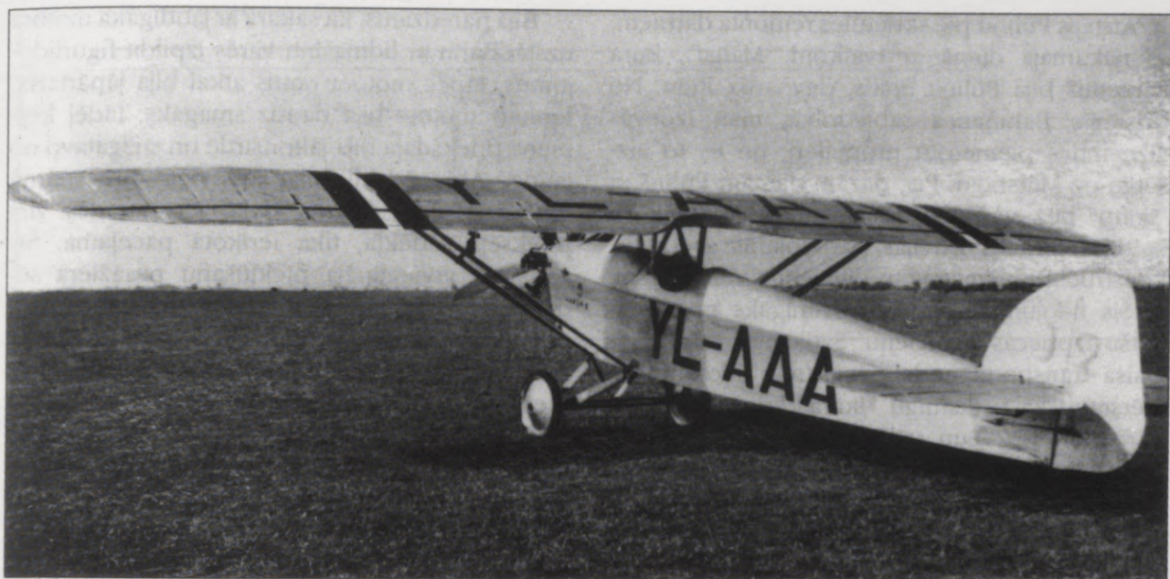
N. Pūliņa P-3 (I-2) "Ikārs" pēc pārbūves Kristīnes Bahmanes rūpnīcā: jaunas metāla konstrukcijas skrietules, dzinēja stiprinājuma mezgls un ugunsdroša starpsiena, alumīnija plūdlīnijas motora pārsegs
