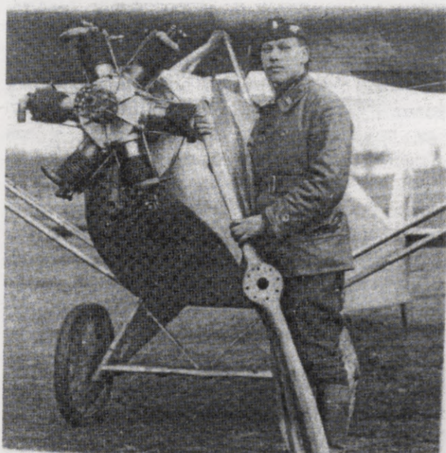
Kārlis Irbītis Aviācijas pulka uniformā pie "Ikāra" ar bojātu propelleri (piespiedu nosēšanās). Labi saskatāms "Anzani" dzinējs
