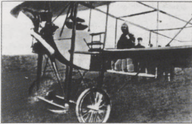
Jāņa Steglava pirmais konstruētais un uzbūvētais divplāksnis "Divplāksnis Nr.1", izmantots ar ūdeni dzesējams 100 ZS "Argus" dzinējs (foto no krievu žurnāla "Samoljot")
