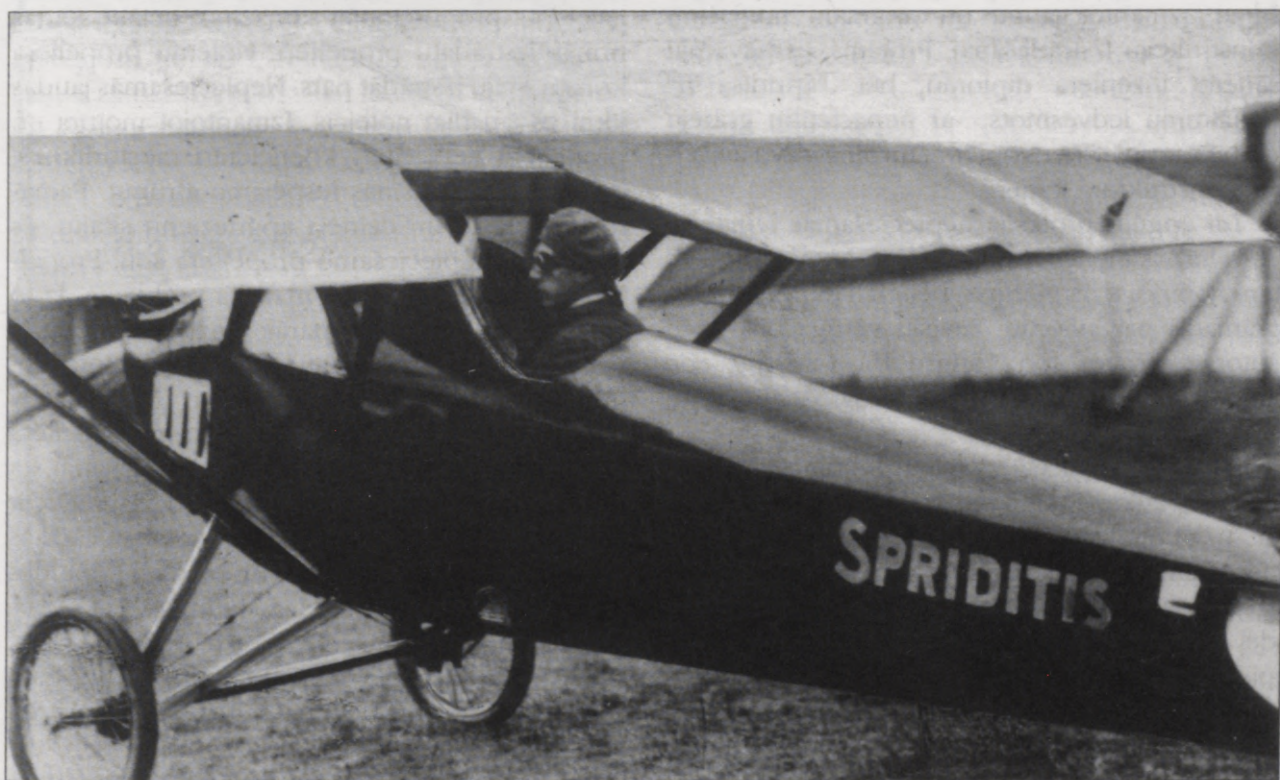
Augšējā attēlā: Nikolajs Pūliņš ar savu "Sprīdīti" P-2, pirmo K. Irbiša konstruēto lidmašīnu ( Veilanda foto no P. Brankes personiskā arhīva ). Apakšējā attēlā: pēc divplāksņa "Sprīditis" P-1 avārijas K. Irbitis jaunajā P-2 izmantoja saglabājušos ķermeņa astes daļu un dzinēju ( foto no N. Pūliņa personiskā arhīva )
