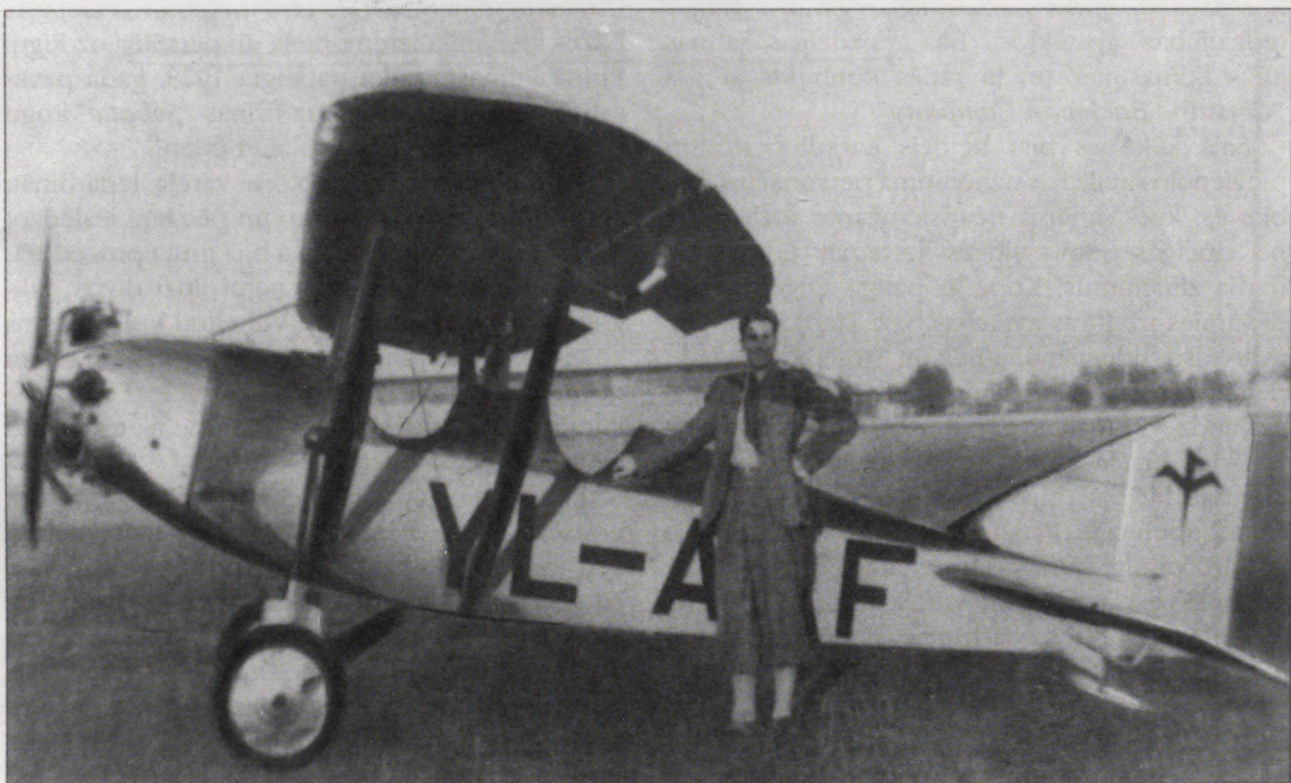
Lidmašīna "Vanadzīņš" I-4 bija K. Irbiša veiktais K. Zārdiņa nepabeigtā vienvietņa turpinājums, izveidojot to par divvietīgu lidmašīnu ar 45 ZS "Anzani" dzinēju
