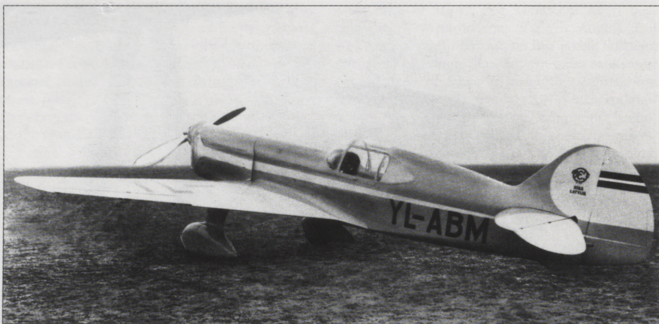
Militārā mācību lidmašīna VEF I-14 YL-ABM ar sešcilindru 200 ZS "Menasco Buccaneer" dzinēju
