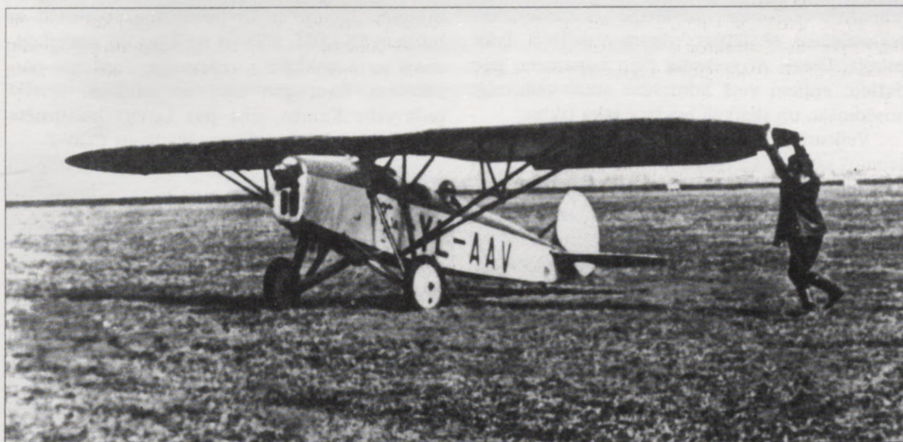
YL-AAV ar pārbūvētām skrietulēm (foto no A. Gerbera personiskā arhīvā)
