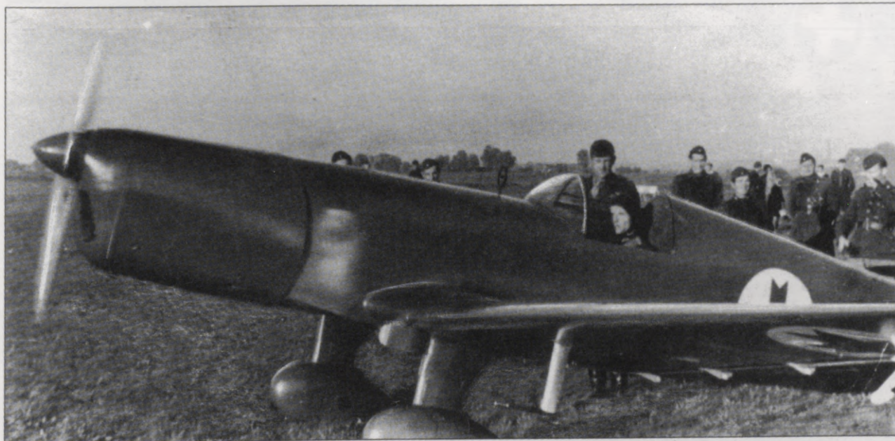
Divas no četrām Aizsargu Aviācijas pasūtītajām VEF I-12 lidmašīnām bija vienvietī. Kreisās skrietales priekšpusē uz spārna uzmontēts Lielbrieža "foto ložmetējs" (foto no A. Gerbera personiskā arhīva)
