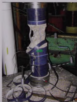
6. att. Stiegotas kolonnas sabrukums
