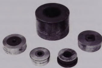
2. att. Sarežģītas formas (a) filtrs no bronzas pulvera un (b) filtri no cieta sakausējuma
