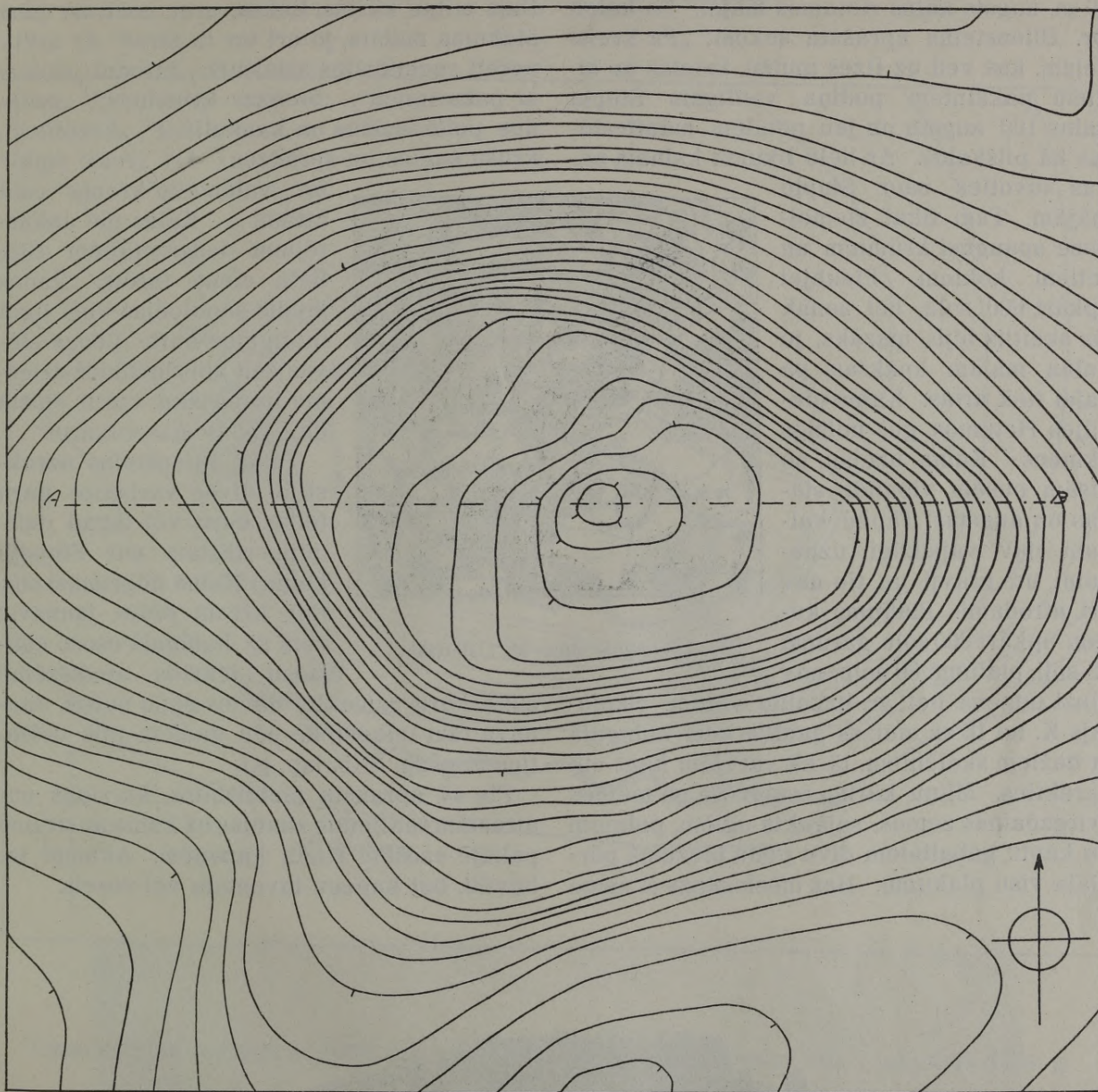
Uzmērojuma mērogs 1:1000; griezumu augstums = 1 m.; uzmērots 23. jūnijā 1924. g.
