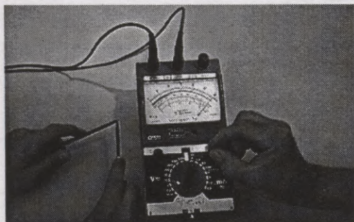
18.7. attēls. Nulles stāvokļa iestādišana pretestības mērīšanai ar mākslīgu īsslēgumu
