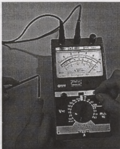
2.17. attēls. Pirms uzsākt pretestības mērīšanu, ir jārada mērvadu issavienojums un uz skalas jāieregulē nulles stāvoklis
