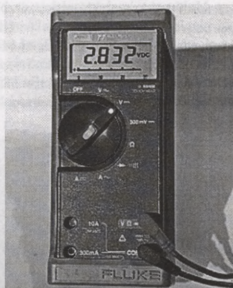
2.10. attēls. Digitālais multimetrs. Pārgriežot pārslēdzi vajadzīgajā stāvoklī, var izvēlēties, vai mērīt līdzstrāvu, maiņstrāvu, līdzspriegumu vai maiņspriegumu vai arī pretestību
