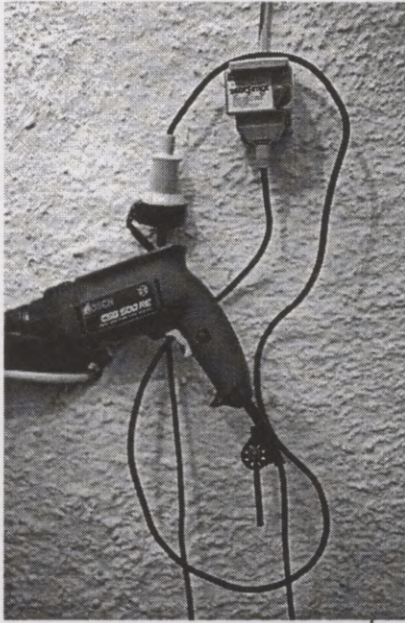
21.9. attēls. Aizsargatslēdzis aizsardzībai pret bojājumiem un kļūdainu pieskaršanos pārnesamiem elektroinstrumentiem
