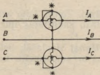
2.12. att. Jaudas mērīšana nesimetriskai slodzei.
