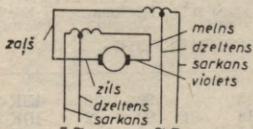
9.4. att. Slēguma shēma 02 un 03 lieluma universālajam elektrodzinējam.
