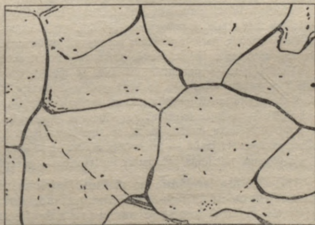
141. att. Metāla mikrostruktūra (palielinājums — 100 reižu).
