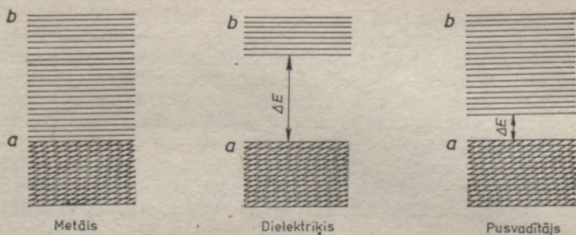
138. att. Enerģijas zonu izvietojums metālā, izolatorā un pusvadītājā (shēma): a — valences zona; b — vadītspējas zona.
