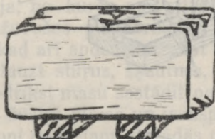
31. zīm. Jēlķieģeļu veidošanas kļūdas — „pūķa zobi“.
