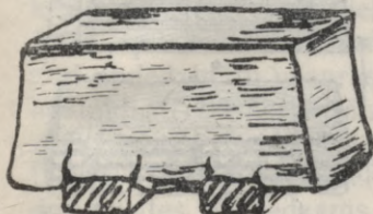
30. zīm. Jēlķieģeļu veidošanas kļūdas — deformācija palielināta karjera mitruma dēļ.
