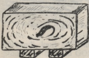
32. zīm. Jēlķieģeļu veidošanas kļūdas — S — plaisa.
