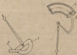
8-2. att. Elektromagnētiskais un gaisa slāpētājs.
