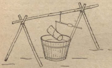
68. att. Tilpuma noteikšana ar svaru metodi
