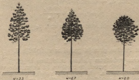
112. att. Augošu koku masas pieauguma procenta noteikšana; Turska rādītāji atkarībā no augstuma pieauguma
