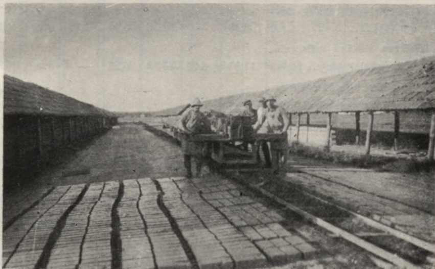
9. att. Izveidoto «balto ķieģeļu» izklāšana žāvēšanas lauciņos.
