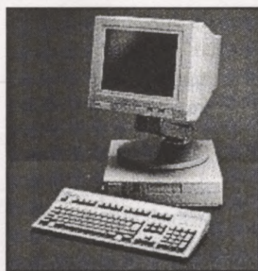
405. attēls. Ekrāns, kuram brīvi var izmainīt tā novietojuma augstumu un leņķi attiecībā pret lietotāja acīm.
