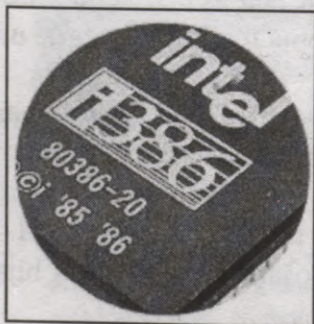
211. attēls. Procesors Intel-386 sastāvēja no 275 000 tranzistoriem.
