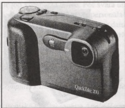
252. attēls. QuickTake 200 ir digitālā fotokamera krāsainu attēlu uzņemšanai, paredzēta MAC datoru lietotājiem.
