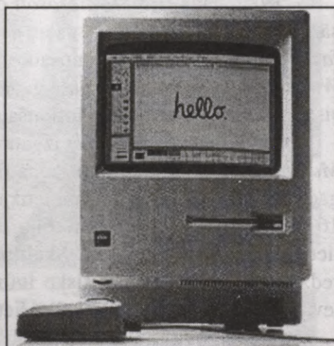
205. attēls. Macintosh izmantoja Motorola 68000 16 bitu mikroprocesoru, tam bija iebūvēts 9 collu monohroms ekrāns. Salīdzinot ar Lisa , Macintosh bija lēts. Tā cena bija $ 2 495.
