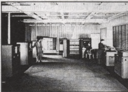
135. attēls. IBM-701. Sastāvēja no 4000 elektronu lampām, 12 000 diodēm. Tā ātrdarbība bija 2000 reizināšanas op./s. Pirmais skaitļotājs, kas izgatavots speciāli biznesa vajadzībām. IBM-701 ir daudzi jauninājumi, to starpā operatīvā atmiņa, kā arī ārējā atmiņa uz magnētiskajām lentēm.
