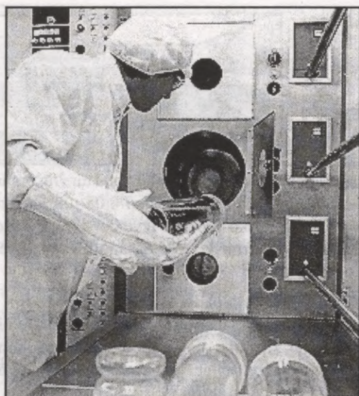
307. attēls. Plāksnišu ielikšana oksidēšanas krāsnī.
