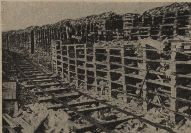
9. att. Zāģētavu atkritumu novietošana žāvēšanai Somijā. Veitsiluoto zāģētavā; fot. inž. J. Gaiķis.
