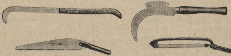
15. att. Augšā — naži zaru nociršanai un sastrādāšanai. Apakšā — zāģis vienrocis un sastiepjams zāģis zaru nogriešanai.
