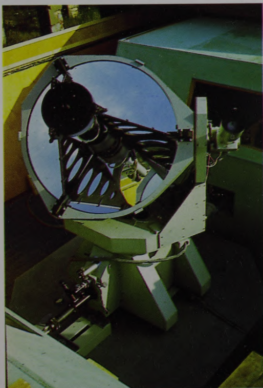
Pavadoņu lāzertālmērs LU Astronomiskajā observatorijā. Teleskopa spoguļa diametrs 1,05 m.
