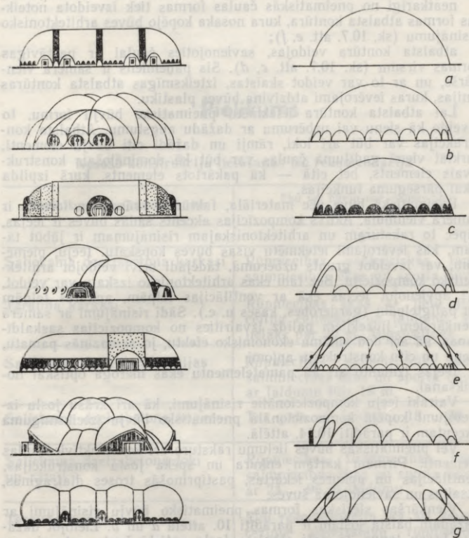
10.15. att. Vienkāršas sfēriskas formas pneimatisko būvju arhitektūras kompozīcijas risinājumi ar dažāda tipa atsaīšu konstrukcijām:
