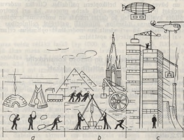
2.1. att. Ražošanas spēki un līdzekļi nesošo konstrukciju attīstības etapos: a — cilvēku muskuļu izmantošana celtniecībā; b — vienkāršu mehānismu (sviru, veltņu, riteņu u. c.) izmantošana celtniecībā; c — būvdarbu mehānizācija un automatizācija.
