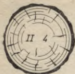
1.3. att. Marķējums 2. šķiras vispārīgas nozīmes zāgmateriālu ražošanai paredzētam zāgbaļķim ar tievgaļa diametru 14; 24; 34; ... cm
