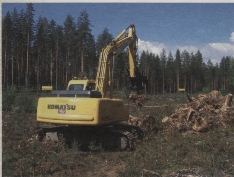
7. att. Celmu raušana ar kāpurķēžu ekskavatoru, kam ir modificēts kauss
