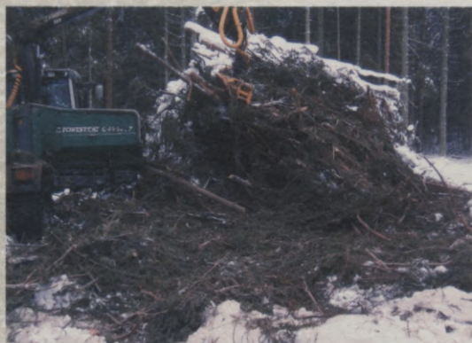
3. att. Mežizstrādes atlieku šķeldošana ziemā
