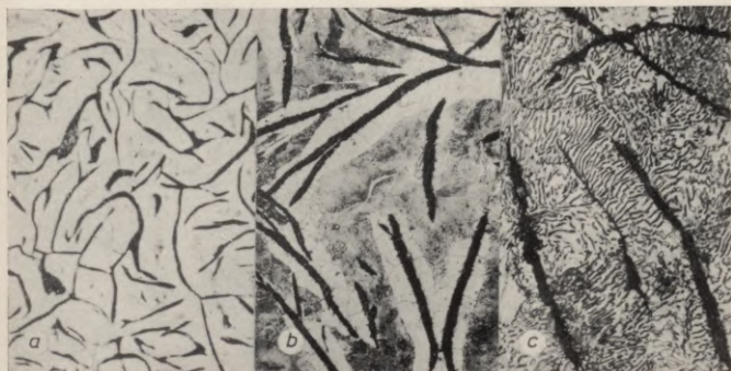
VII att. Pelēko čugunu mikrostrukturās ( \times 200 ): a — ferīts un grafiņš; b — ferīts, perlīts un grafiņš; c — perlīts un grafiņš.
