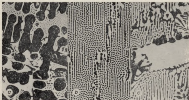
II att. Balto čuguna mikrostrukturās (×200):
