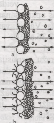
3.38.att. Dūmgāzu filtrācija caur audumu. a - ar gludiem pavedieniem; b - ar izpūrušiem pavedieniem.
