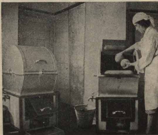
72. att. Rokas veļas mazgājamā mašīna, kurā līdz ar veļu ieliek koka bumbas un tad mazgā.
