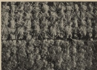
76. att. Augšā — labi izskalots audums, apakšā — slikti izskalots audums.
