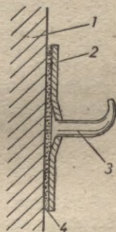
13. att. Kāša pielīmēšana betona sienai
