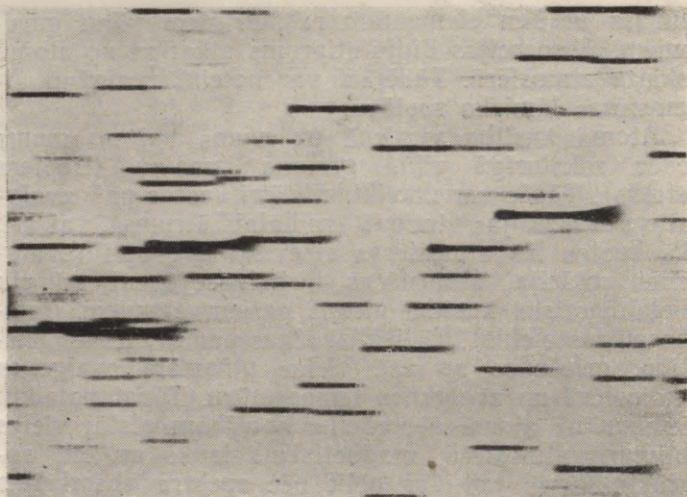
13. att. Zvaigžņu spektri, kas uzņemti ar prizmas kameru.
