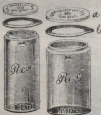
35. zīm. Burku noslēgšana. Stikla vāks a, gumijas riņķis b. Riņķi pārklāj virs burkas malas, tad uzliek vāku.
