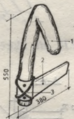
2.9. att. Mērlīste: 1 — atdura; 2 — līste; 3 — dzelkņi
