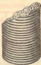
3.7. att. Grafiīta virsmas attēls 1,5 \cdot 10^7 reizu palielinājumā. Attēlā redzamās joslas ir oglekļa atomu slāņi.
