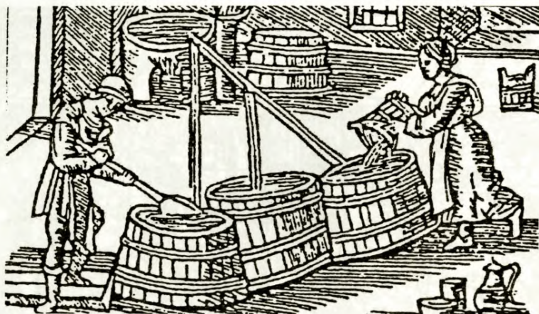
52.att. Misas gatavošana. Iesala miltus lielā kublā aplej ar karstu ūdeni un ar menti sajauc. Ūdens vārās iemūrētā katlā ar kurtuvi zem tā (Magnus 1567) [63].
