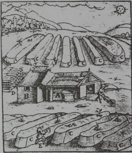
56.att. Salpētra dārzs. A,B – salpētra vārtava, C – komposta kaudzes salpētra „audzētavas” no kūtsmēsliem un mūra salpētra [90].
