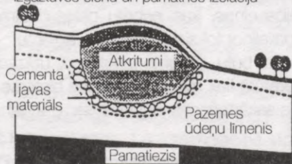
3.4. att. Izgāztuves ietekmes uz pazemes ūdeņiem samazināšanas metodes (Landfilling, 1994)
