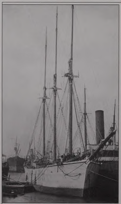
Gafelšoneris Uranus . Uzbūvēts 1908. gadā Kaltenē. 279 BRT/237 NRT. Piederības osta Rīga. Uranus veda kravas pāri Atlantijas okeānam. 1927. gadā pārdots īpašniekiem Lielbritānijā.
