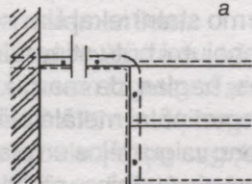
5.198. att. Kāpņu margā, savienotā ar sienā iestiprinātu podesta margu: a – sānskats; b – virsskats
