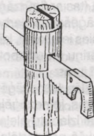
5.29. att. Šablons apaļkoka pārzāgēšanai garenvirzienā
