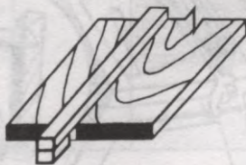
5.27. att. Šablons ar atduru vienā galā vienāda garuma dēļu nozāģēšanai
