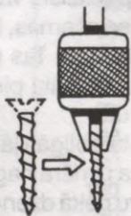
5.64. att. Kokskrūves iestiprināšana urbjmašīnā vītnes veidošanai
