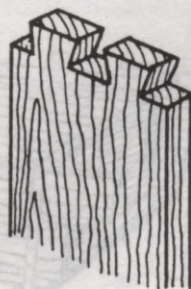
5.77. att. Stūra savienojums ar ķetnveida jeb bezdelīgastes veida dzeguļiem
