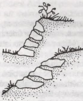
4.5. att. Nogāžu nostiprināšana ar akmeņiem
