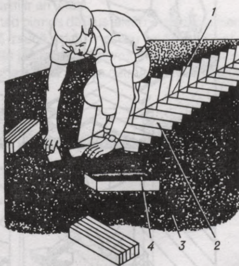
5.177. att. Virzienskujiņu rindas ieklāšana: 1 – virzienaukļa; 2 – gabalparketa dēlīši; 3 – papīrs, kartons vai pergamiņš; 4 – naglas
