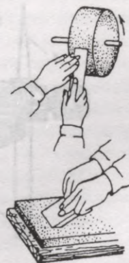
5.17. att. Ēvelnaža asināšana: a – uz slīpriipas; b – uz galodas
