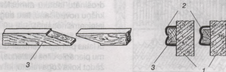
2.18. att. Koka žoga šķērskoku salaiduma mezgls ar slīpu taisngala pārlaidumu metāla aptverēs: 1 – žoga stabi; 2 – metāla aptveres; 3 – šķērskoks
