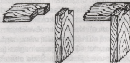
5.86. att. Koka elementu stūra savienojums puskokā
