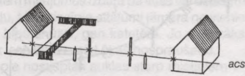
3.1. att. Ēkas fasādes galvenās ass līnijas noteikšana
