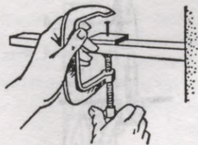
5.57. att. Naglas iespiešana koksnē ar spīlēm
