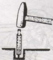
5.60. att. Naglas iedzišana grūti pieejamā vietā, izmantojot caurulītē ievietotu stieni
