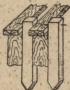
Zīm. 162. Starp rāmīšiem ievietoti \frac{1}{2} " biezi klucīši, lai rāmīši pie pārvadāšanas nesvārstītos.
