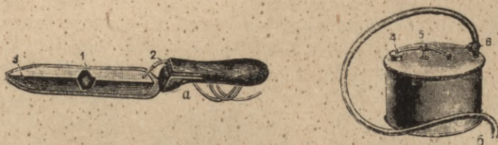
Zīm. 230. Ar tvaiku karsējams nazis: a — nazis, 1 — naža iekšiene tukša, 2 — tvaiku pievadītāja caurule, 3 — caurums tvaika izplūšanai; b — tvaika katliņš, 4 — caurums ūdens ieliešanai, 5 — drošības atspere, 6 — tvaika vads.
