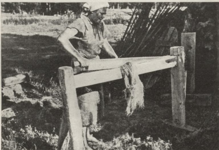
104. att. Linu mīstīšana. Kreisajā rokā mīstītāja tur starp mīstiklu pamata un vāka šķautnēm novietoto linu sauju, bet labajā rokā mīstiklu vāka rokturi ( minturi ), ko tā atkārtoti paceļ un nospiež pret pamatu. Valgundē, 1936. g. (Autora uzņ.)
