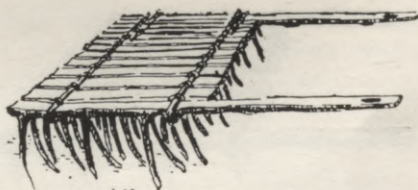
15. att. Zaru ecēšas. To galdus kopā satur divi apkārt apliektas lunkanas bērzu klūgas. (Bilenšteins.)
