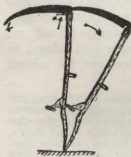
34. att. Izkaptis ir līdzīga, ja, to pieslejot pie sienas un apzīmējot vietu, kur tās asmens platā gala stūris pieskaņas sienai (a), un pagāžot to nedaudz pa labi, arī izkopts asmens smailajā galā (b) pieskaņas šai pašai vietai (a). (Autora zīm.)
