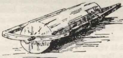
21. att. Vellenis . Tā asi veido divi dzelzs tapas, kas griežas laņķertu sānkokos. (Bīlenšteins.)
