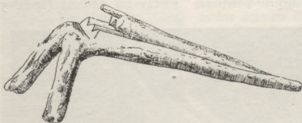
99. att. Mīstīklas . To viens gals balstās pret zemi, otrs uz divi koka kājām, kas veidotas no tā paša koka zaru izaugumiem. Krustpīli. (Pāvuliņa.)
