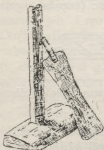
107. att. Kulstīklas galdiņš iestiprināts koka šķilā. Krustpīli. (Pāvuliņa.)
