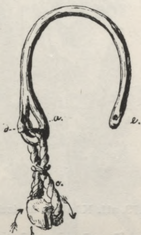
172. att. Kāsis dzeiņa pīnes atbalstīšanai. (Bilenšteins.) a) auss, b) liedzējs, c) virves gredzens, d) osa, kuŗā iemauc gaŗās kārtiņas augšgalu, lai kāsi uzkabinātu uz kāda zara virsdores, e) caurumiņš, kuŗā iesien auklu, ar kuŗas palīdzību kāsi dabū atkal zemē.
