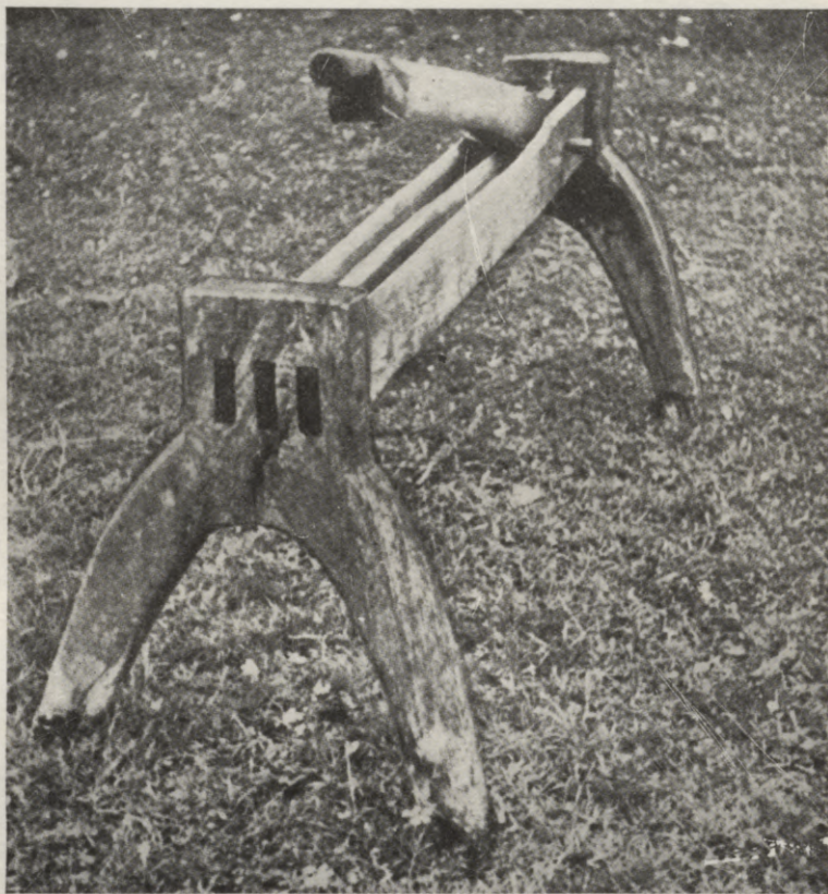
101. att. Mīstīklas . To kājas abos galos veido spēcīgi bērza divžuburi. Tērvetē, 1943. g. (Autora uzņ.)
