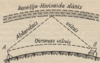
103. zīm. Raidītāja A radioviļņi radio- uztvērēja B antenā nonāk pa diviem dažādiem ceļiem: izplatoties paralēli Ze- mes virsmai (virsmas viļņi) un atsta- rojoties no augšējiem atmosfēras slā- ņiem (telpas viļņi).
