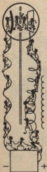
50. zīm. Anodstrāva, izplūstot cauri pretestībai R , rada sprieguma kritumu, kas, izrādās, ir pievadīts starp tikliņu un radiolampas katodu.
