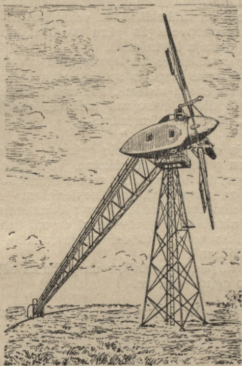
34. zim. Vēja elektrostacija ЦАГИ-Д-30 ar jaudu līdz 100 kilovatu.
