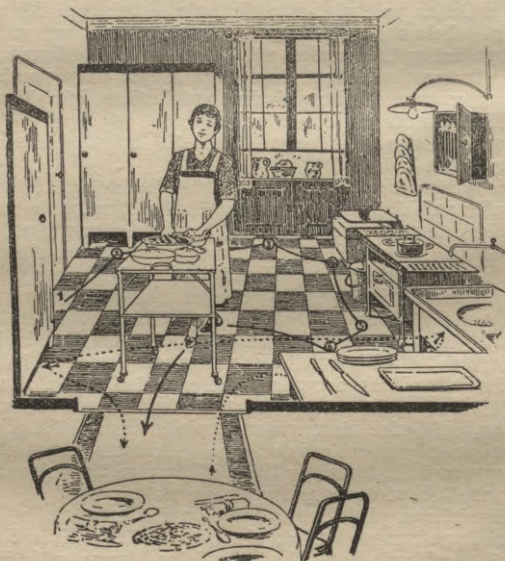
37. zīm. Pareizi iekārtota virtuve. 1. Pieliekamās telpas. 2. Retāki lietojamo trauku un produktu skapis. 3. Trauku skapis. 4. Plīts un atkritumu spainis. 5. Ūdens krāns un izleja. 6. Produktu sagatavošanas galds.
