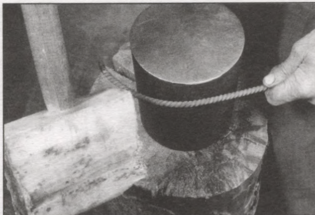
Kad vijumu blīvums sasniegts un vidusdaļa pārkalta tievāka, kaklagredzena formas veidošanai noder apaļš klucis un koka veseris.
