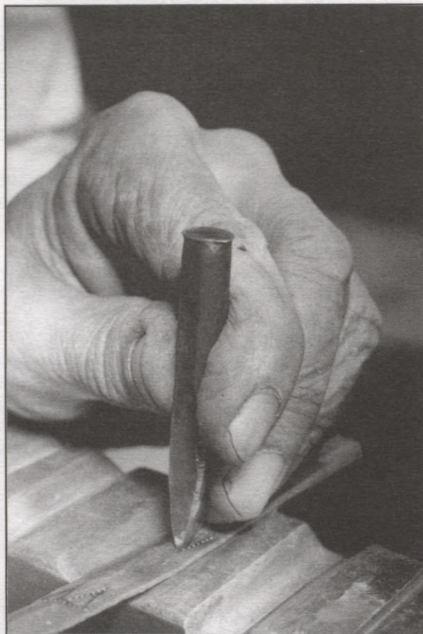
Raksta iekalšanai aproces virsmā noderīga lēzena trīsstūra veida gropē, kur sagatave stabili atbalstās.
