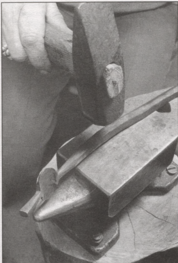
Seglu – kāšu kaklagredzena loku romba šķērsgriezumā kaļ uz līdzenas laktas virsmas.
