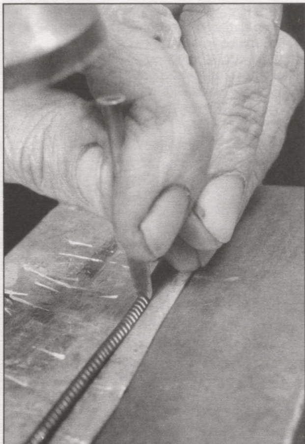
Gredzena galiem imitētā vijuma rievojumu iekāļ ar pusapaļa (ieliekta) cirtņa palīdzību uz līdzenas laktas virsmas.
