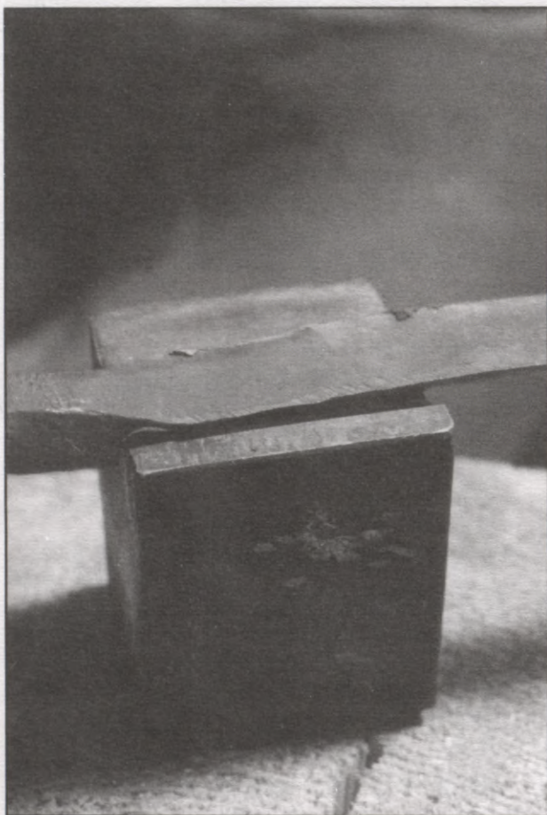
Laktiņas trīsstūra gropē kaļ attiecīga šķērsriezuma zvērgalvu aproces sagatavi. Laktas kreisajā pusē redzams galvas veidošanai atstātais masīvais četrskaldņu gals.
