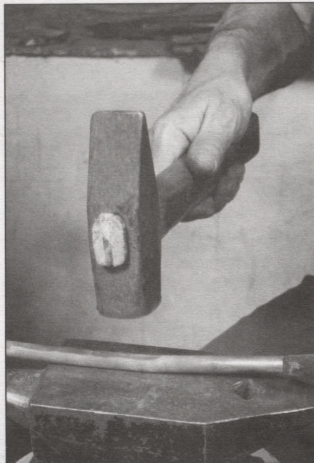
Apaļa šķērsriezuma stieni kaļ kvadrātā, vispirms to noplacinot uz līdzenas laktas virsmas.
