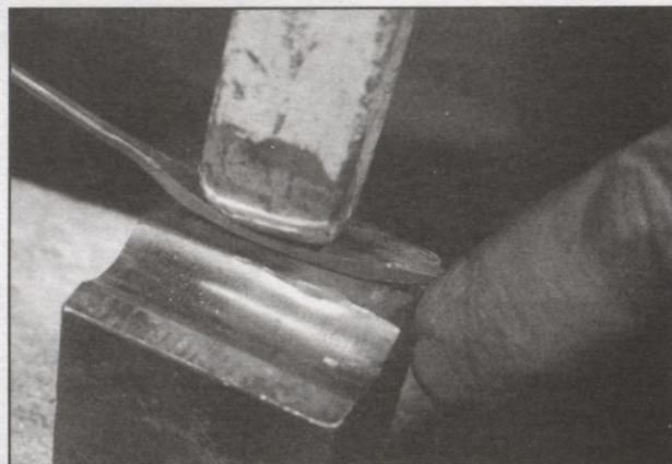
Profilētajam gredzenam vidusplāksnīti kāļ laktas rievā. Sagataves vidusdaļā veidojas garenvalnītis. Metāls abpus tam noplacinās.
