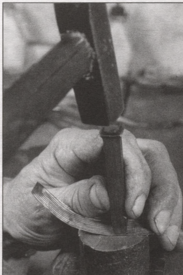
Rievu iekalšana skārda cilindriņu sagatavēs.
