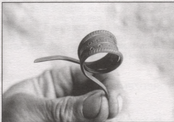
Gredzena gali jānokniebj, jāpievīlē un jāpiekļauj lokam.
