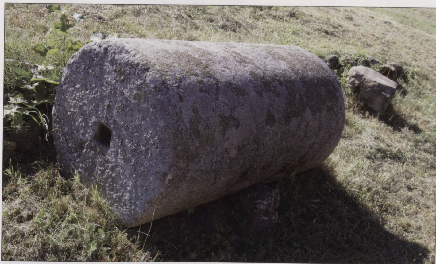
Pie Sēlpils novada muzeja aplūkojams ceļu būvniecības vēstures pieminēklis – no akmens darināts ceļu būves rullis
