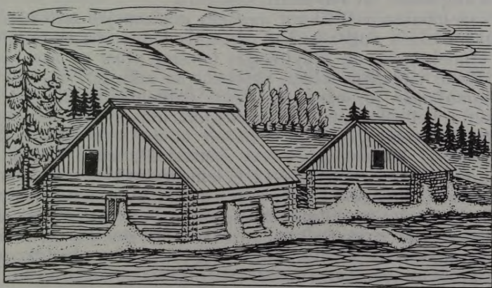
73. Uzledus veidošanās. Grunts veidotie uzledi, kas applūšina ēkas.
