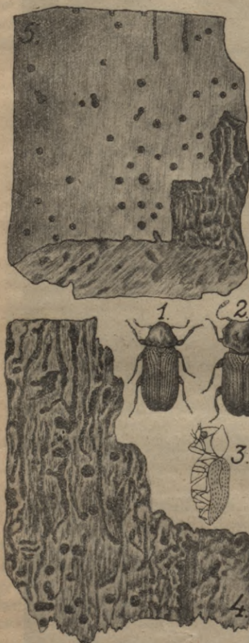
Zim. 13. Ķirmēji: 1—3. vaboles, 4. sa-grauzta koksne, 5. vaboļu izskrejas caurumiņi. (Pēc Ešericha).
