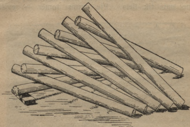
Zīm. 7. Otrs koku žāvēšanas veids, tomēr ne tik izdevīgs kā № 6.
